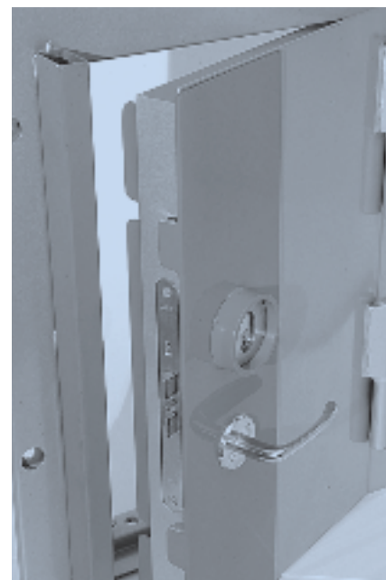
Falsad branddörr. Princip för förstärkning av ståldörr.
